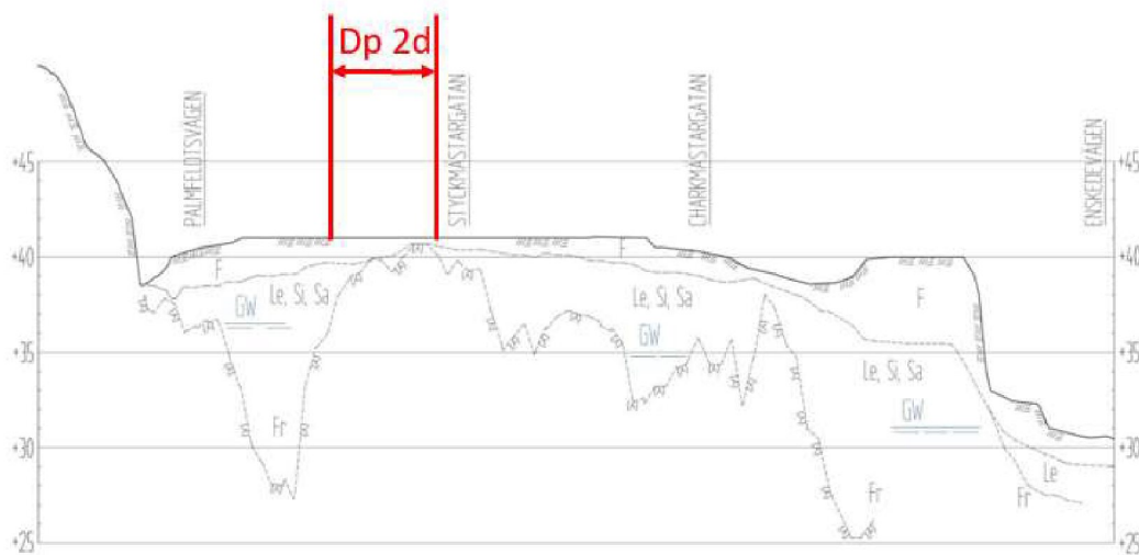
Bild 3. Tolkad sektion med ungefärlig utbredningen av Dp 2d markerad. (Källa WSP)
