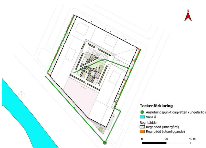
Figur 13-2. Exempel på hur dagvatten från regnbäddar leds via ledningsnät för dagvatten från Kvarter I mot befintlig anslutningspunkt för dagvattenssystemet.
