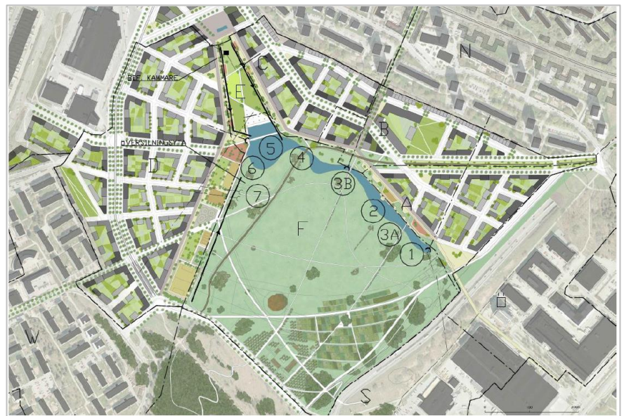
Figur 5-1. Avrinningsområden för planerad exploatering av Årstafältet. Utredningsområdet Kvarter I innefattas av delavrinningsområdet A, där dagvatten leds mot Valla Å, vidare mot Valla damm (5). Figur från Sweco (2012).
