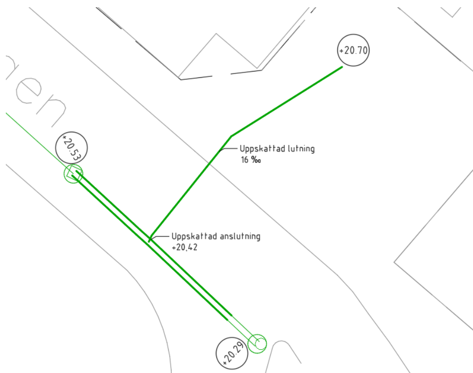
Figur 21 Dagvattenledning som avvattnar ytan framför garageinfarten
