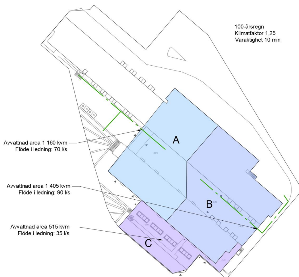
Figur 25 Ledningar bör vara dimensionerade för att ta emot ett 100-årsregn från ytor illustrerade ovan för att inte riskera översvämning på innergården
