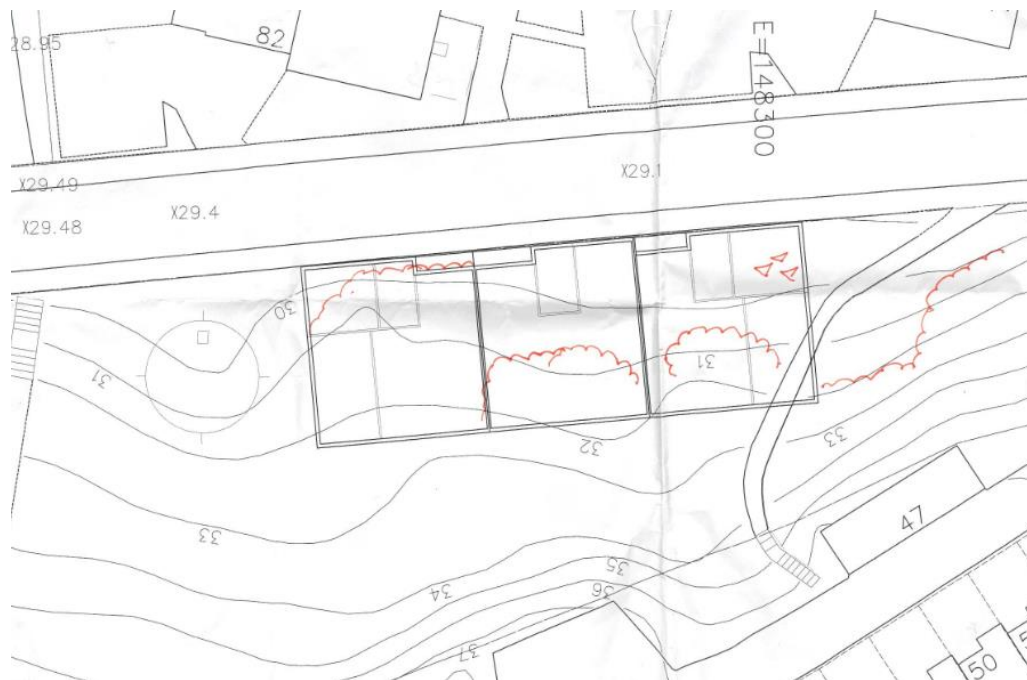
Bild 1. Kartering av berg vid platsbesök.
