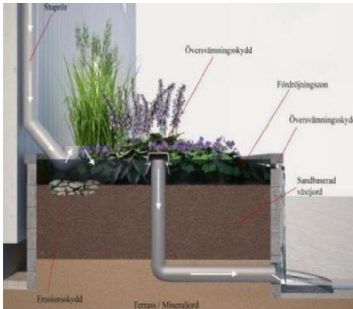
Figur 12. Principskiss över växtbäddskonstruktion med stuprörsanslutning och bräddavlopp.
