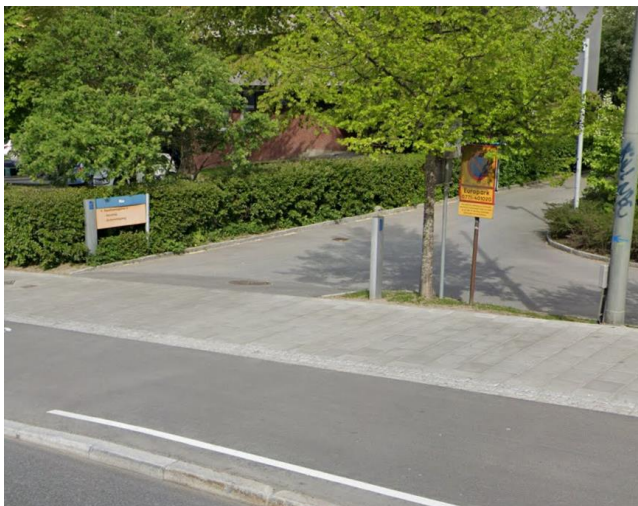
Figur 9 Foto från Värtavägen (från söder) på fastighetsgräns. Skyfallsvatten leds troligtvis längs kantstenen ut till gatan istället för in till fastigheten. Källa: Google Maps
