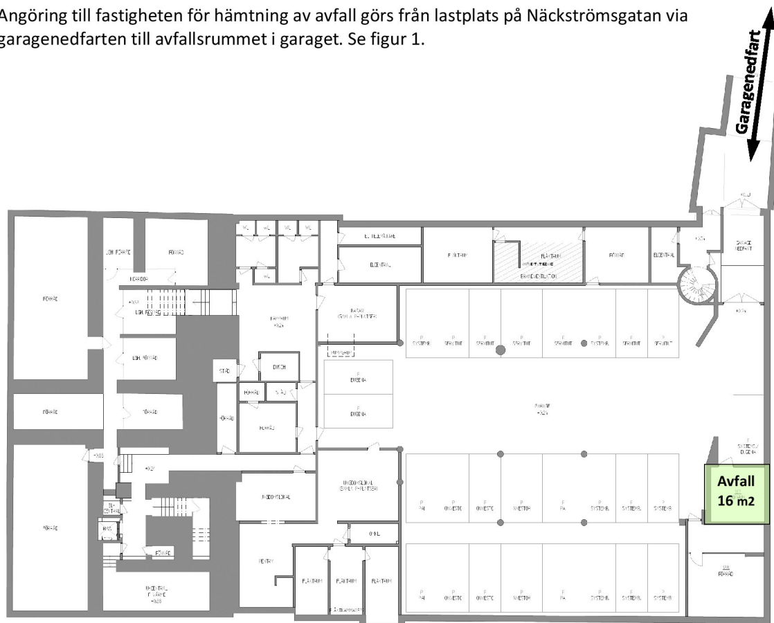
Figur 1: Källarvåning visande avfallsrum och angöring via garagednfart.
