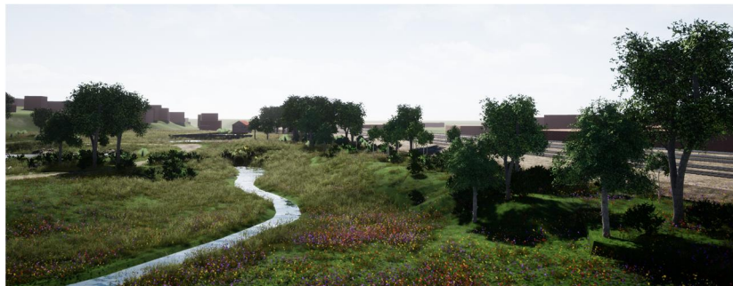
Fig 6 . Projekterad lösning. Å-fåran har flyttats för att öka avståndet till Mälarbanan samt för att skapa fördröjningsvolym mha flacka slänter. Vy mot kulvertens öppning. (Visualisering från 3D modell: Gabriel Lindqvist)
