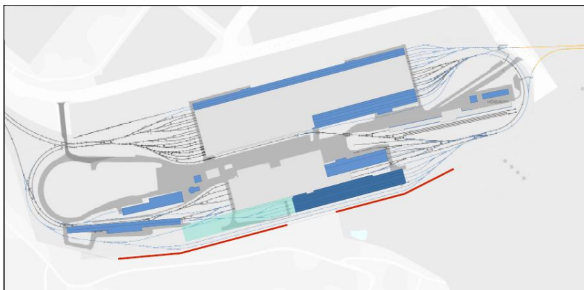
Föreslagna stödkonstruktioner markerade med rött. Befintlig städ- och uppställningshall är markerad i mörkblått och möjlig framtida tillbyggnad i turkost (WSP).
