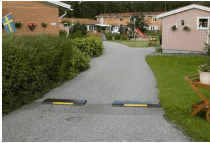
Figur 10 Förslag på fartgupp som sänker fordons hastigheter. Ett fartgupp av denna sort kan relativt enkelt placeras och tas bort utan större omfattande åtgärder (Källa vänster bild: flexibump.se. Källa höger bild: ATA.se).
