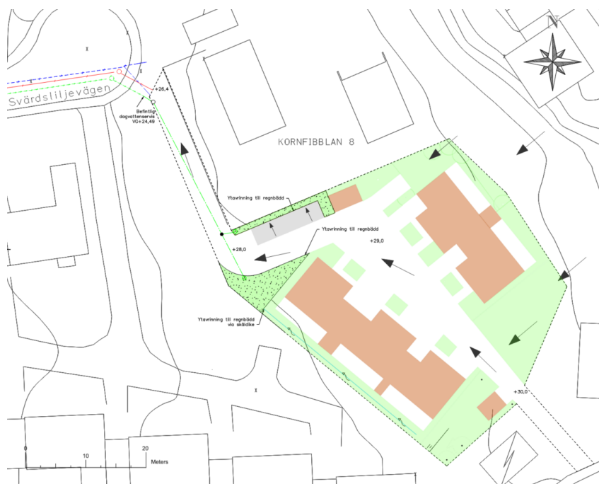
Illustration som visar på framtida dagvattenhantering med grönytor, ytavrinning (svarta pilar) regnbäddar i väster (grönprickad ytor) och svackdike i söder (grön linje med pilar). (Norconsult)
