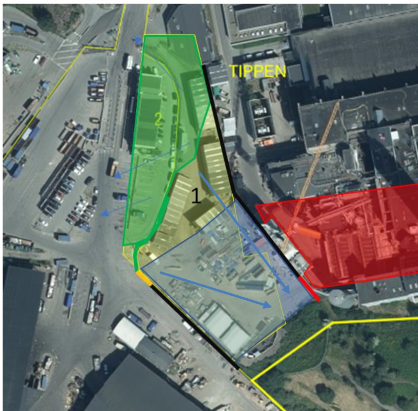
Figur 3. Exempel på åtgärder inom P7-området (gult område) för att uppfylla föreslagen funktionsbestämmelse. Rött område anger lågpunkten som ska skyddas från tillrinning.
