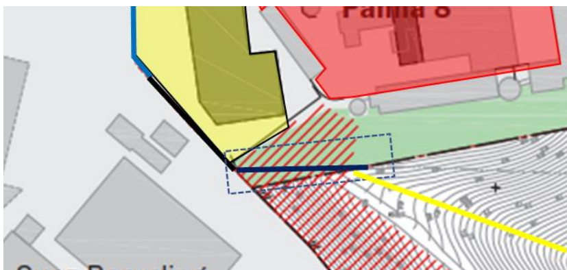
Figur 2. Föreslagen vall ska uppföras inom strekat område (blå rektangel), exempelvis längs blå linje, så att höjdryggen (gul linje) sammankopplas med befintlig mur (svart linje).
