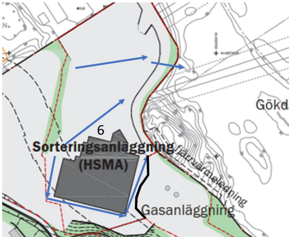
Figur 5. Markens planerade lutning, och därmed även riktning för ytlig avrinning vid kraftiga regn, inom sorteringsanläggningens fastighet (blåa pilar).
