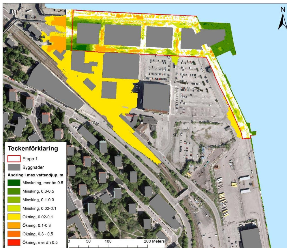
Figur 15: Jämförelse av maximala vattendjup som kan inträffa vid ett skyfall efter utbyggnad av norra delen utan vidtagande av åtgärder mot dagsläget. Bilden beskriver påverkan som norra delen beräknas ha på översvämningssituationen.
