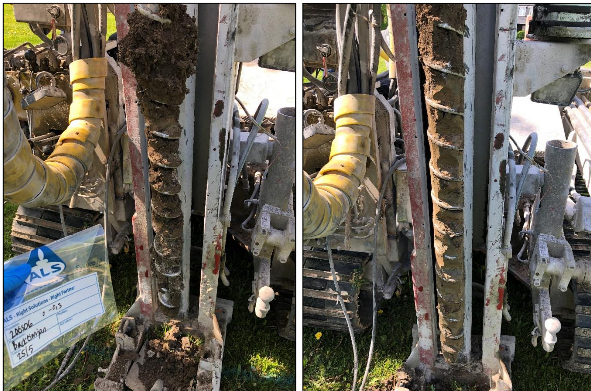
Figur 3 Skruvborr med jordlagerföljd i provtagningspunkt 20GS06. Till vänster 0-1 m, till höger 1-2 m.
