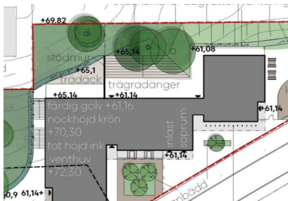
Figur 6b. Förslag på hur ytan mellan byggnaden och naturmarken kan höjdsättas enligt rekommenderad avrinning i Figur 5a för att undvika instängt område. Vid fasad lutas marken utåt 2 % mot diken där vattnet leds bort från huset.
