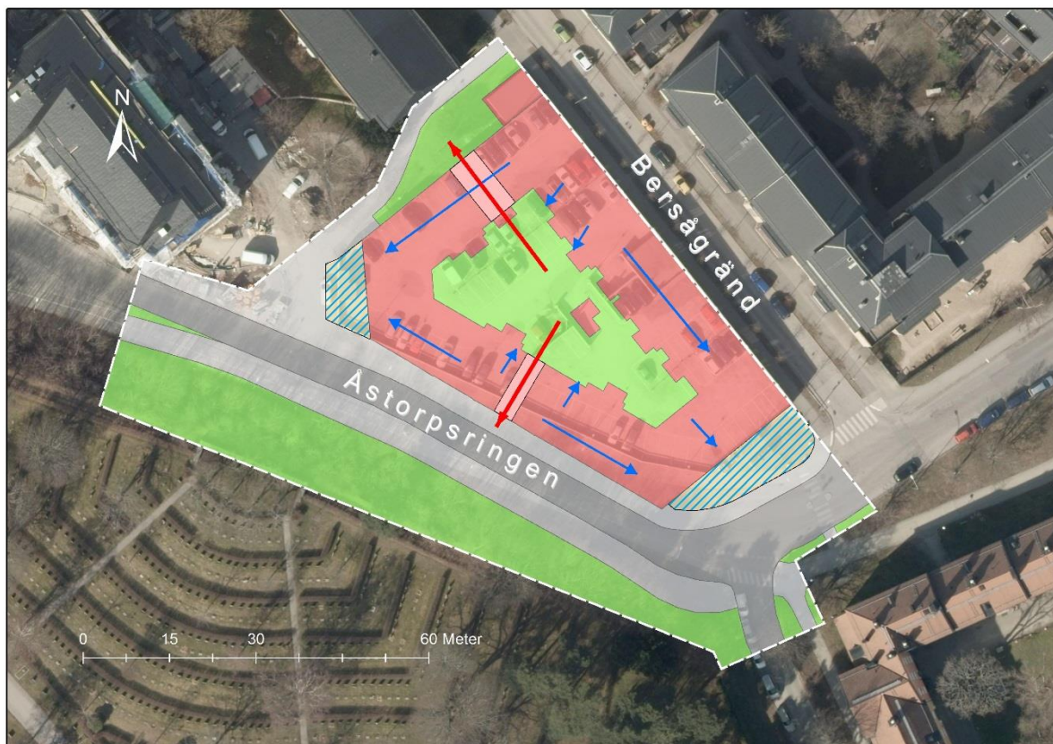
Figur 5-2. Principskiss med ungefärlig placering av makadammagasin (blåstreckad yta) under byggnadens entrétytor. De röda pilarna visar yttlig avrinningsväg för dagvatten genom portikerna (ljusare markering i huskroppen) vid extremregn.
