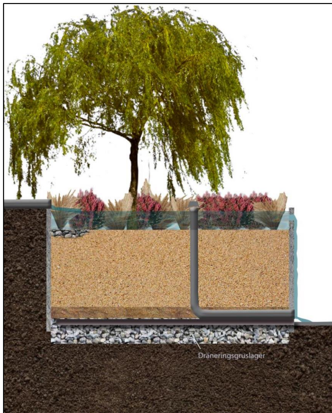
Figur 5-6. Exempelillustration av hur en regnbädd kan byggas upp (Illustration Åsa Wellander).
