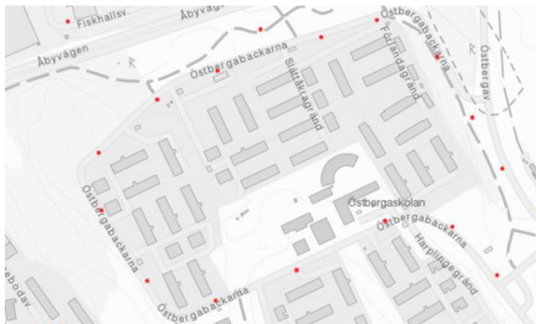
Röda markeringar visar befintliga brandvattenposter (SSBF)
