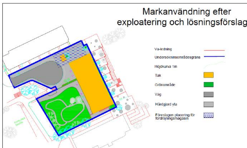
Planerad ny markanvändning och föreslagen placering för fördröjningsmagasin (Geosigma)
