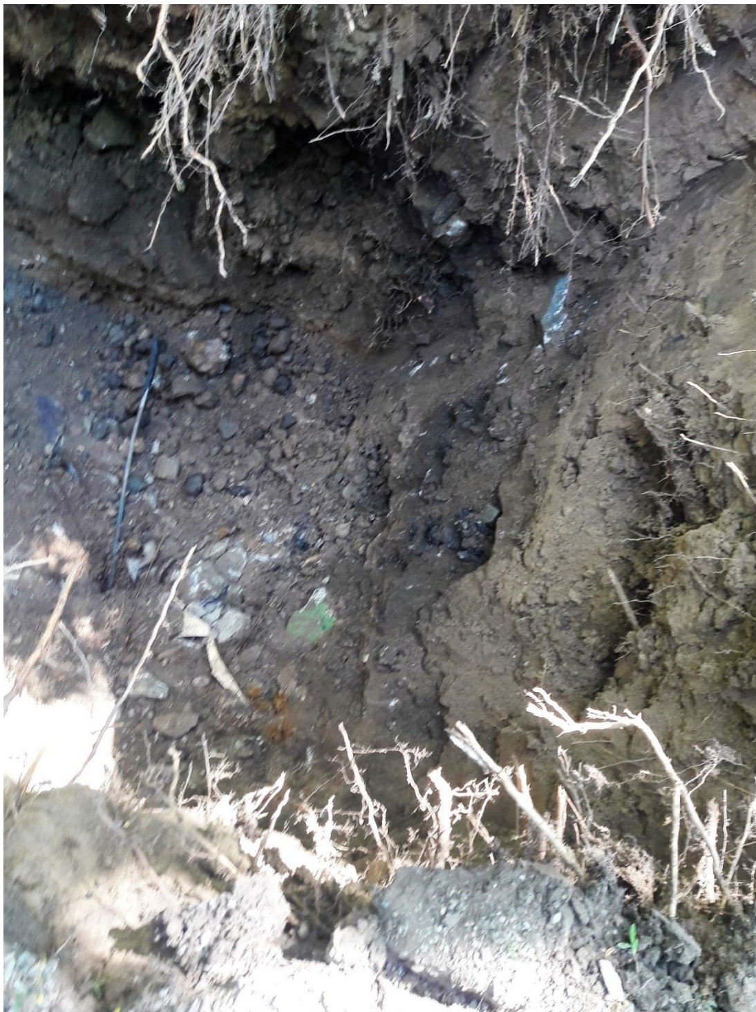
Bild 4: Schaktgrop med tjärasfaltsbitar och rivningsrester från provpunkt 19W01, ca. 0,8 – 1,7 m u my.
