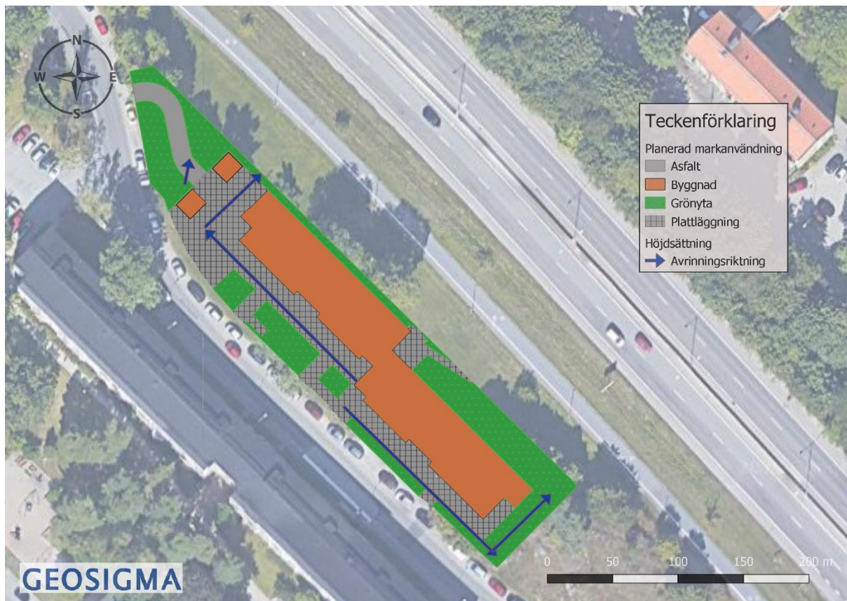
Figur 5-8. Höjdsättnings eftersökta avrinningsriktning markerat med blå pilar.
