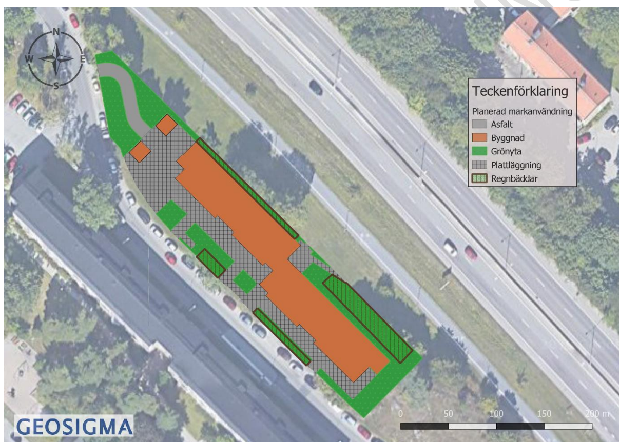
Figur 5-7. Principskiss med ungefärlig placering av föreslagna lösningar för dagvattenhantering. Observera att ortofotot ligger något förskjutet i bilden. Utritade areor är endast exempel och motsvarar inte erforderliga areor.
