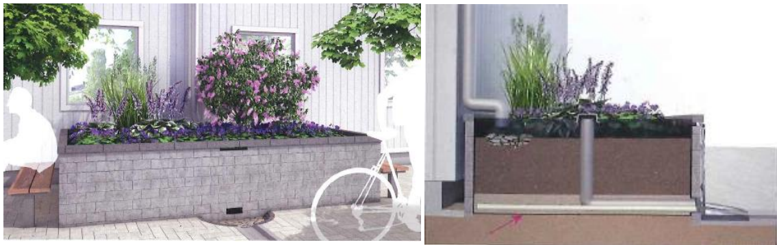
Figur 5. Till vänster: exempelbild på en upphöjd växtbädd/regnbädd. Till höger: sektion av regnbädd med tät duk under så att vatten inte riskerar att skada grundläggning och underliggande konstruktion (Movium, 2015).
