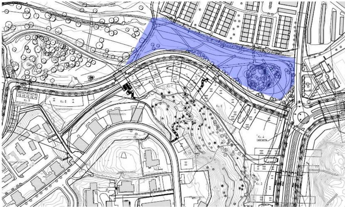
Figur 9 Område där SVOA-ledningar ligger utanför planerade gator som kräver förstärkningsåtgärder
