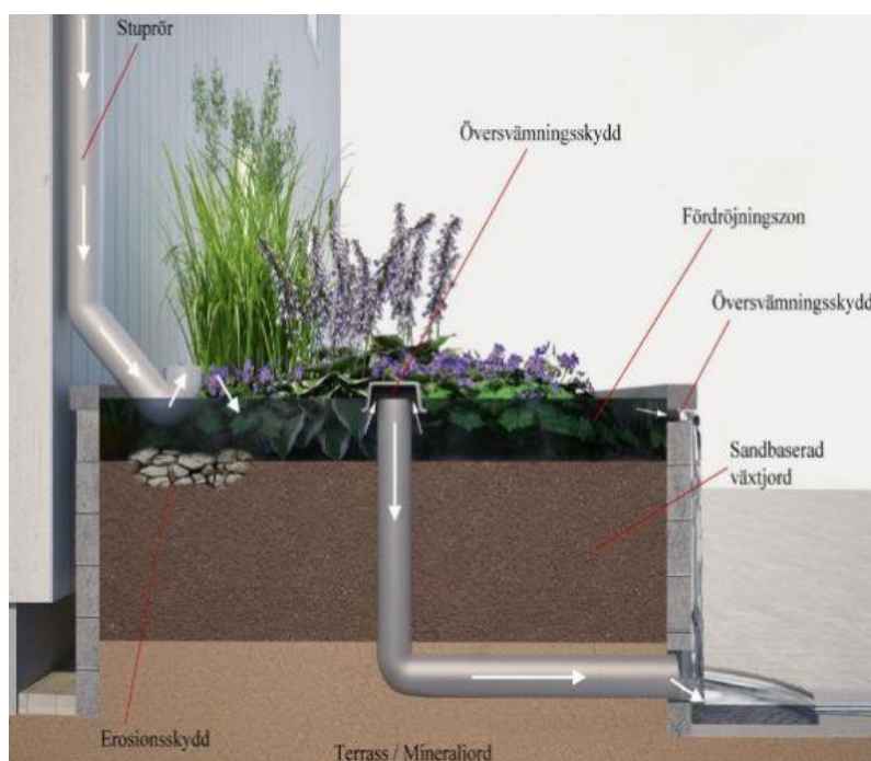
Figur 11. Principskiss över regnträdgård/växtbädd anslutning med stuprör.
