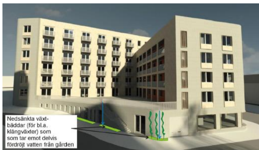
Principförslag nedsänkta växtbäddar längs Mosstenabacken (WRS 2018)
