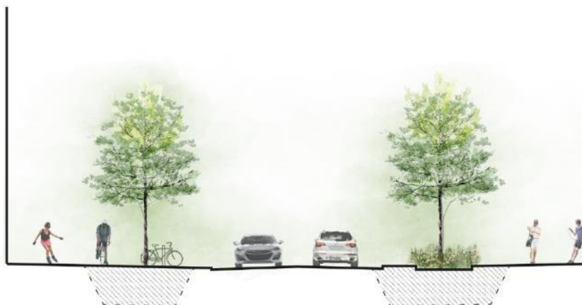
Principsnitt genom gata.. Gator utformas med träd och perenner i växtbäddar i så stor utsträckning som möjligt för omhändertagande av dagvatten.
