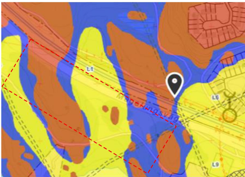
Figur 4.2 Utdrag ur Byggnadsgeologiska kartan. Gul=lera, Blå=morän och Rött=berg
