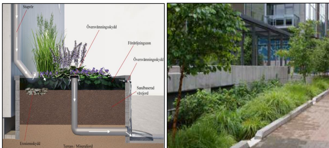
Figur 11. Tv: Tvärsnitt av en växtbäddarna i anslutning till byggnad. Th: Illustration över växtbäddar i ett bostadsområde och stadsmiljö.
