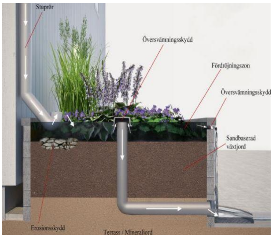
Figur 8. Principskiss över regnträdgård/växtbädd anslutning med stuprör.
