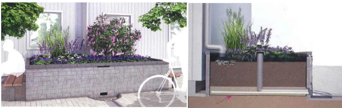
Figur 7 Till vänster: exempelbild på en upphöjd växtbädd/regnbädd. Till höger: sektion av regnbädd med tät duk under så att vatten inte riskerar att skada grundläggning (Movium, 2015).
