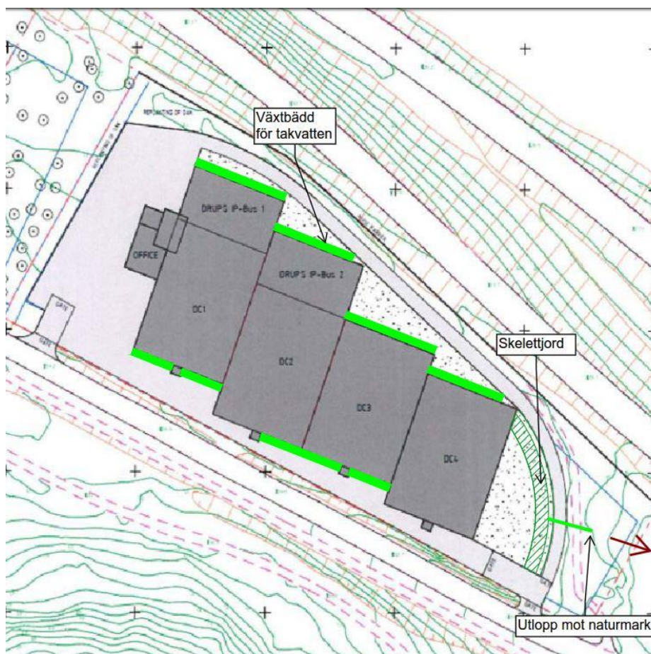
Figur 5 Åtgärdsförslag för dagvattenhantering. Upphöjda växtbäddar för takvatten är markerade med gröna ifyllda partier, och skelettjord för hantera vatten från hårdgjorda ytor är markerad med en grön streckad färg. I skelettjorden kan även biokol tillsättas och träd planteras för en högre reningsgrad. Ledning med utlopp mot naturmark visas i grönt, där pilen anger flödesriktningen.
