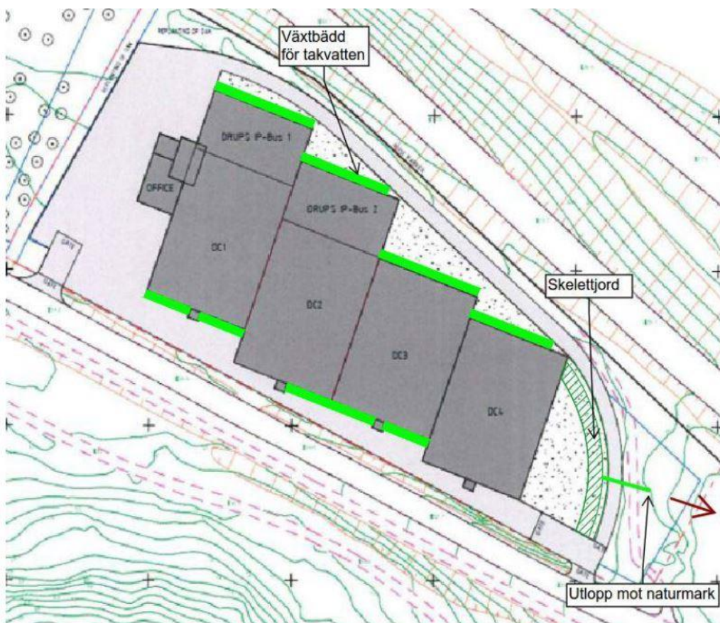
Figur 5 Åtgärdsförslag för dagvattenhantering. Upphöjda växtbäddar för takvatten är markerade med gröna ifyllda partier, och skelettjord för hantera vatten från hårdgjorda ytor är markerad med en grön streckad färg. I skelettjorden kan även biokol tillsättas och träd planteras för en högre reningsgrad. Ledning med utlopp mot naturmark visas i grönt, där pilen anger flödesriktningen.
