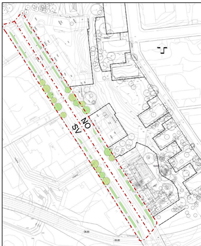
Figur 7 Principskiss över Bolidenvägen (Tengbom, 170613). Delavrinningsområdena SV och NO är markerade med röstreckade linjer. Ytor avsedda för växtbäddar är markerade med grönt.
