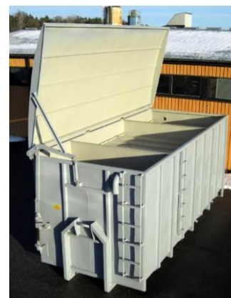
Figur 26 sedimenterings- och reningsanläggning
