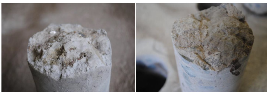
Bild ur KTH:s studie (sid 27) som visar två olika betongkärnor med brott (=noll vidhäftning) i gränsen mellan gammal och ny betong efter pågjutning. Smuts och olja är orsakerna i dessa fall.
