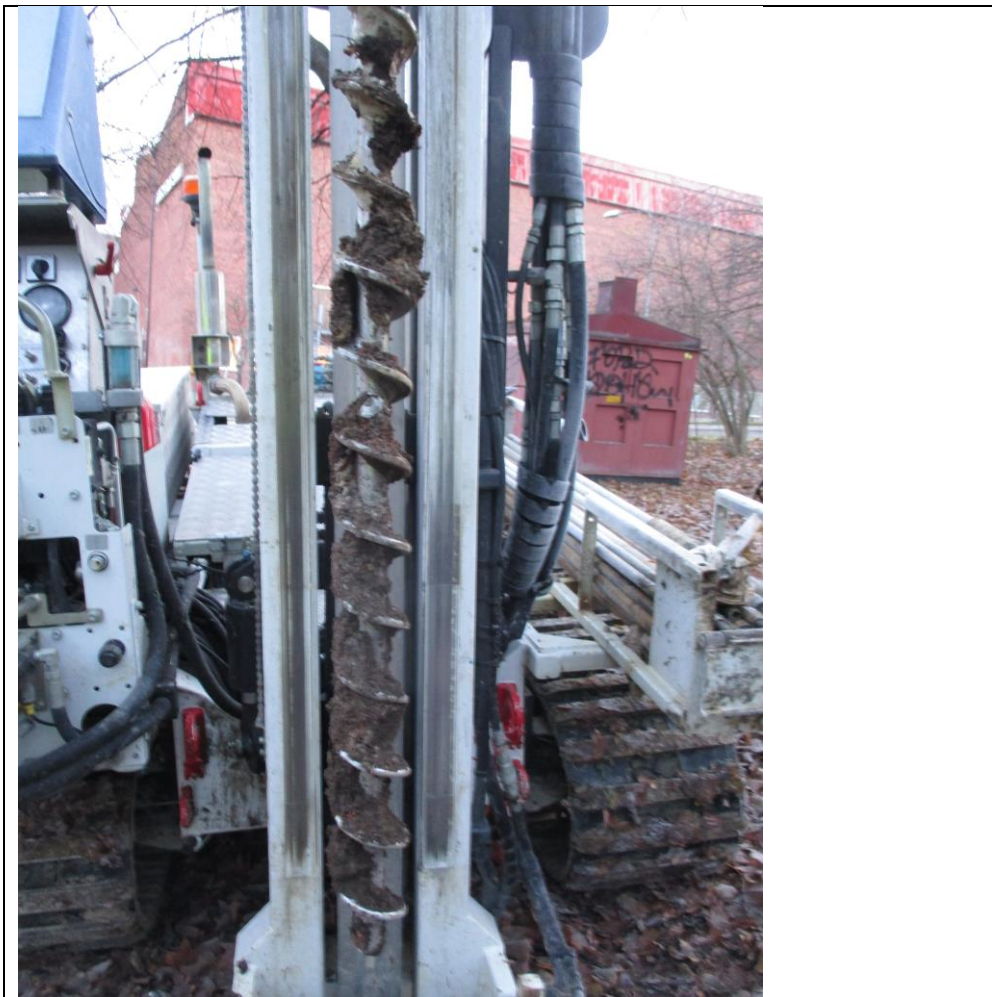
Bild 3. Borrkärna från fyllning vid provpunkt S8, PAH-föreningar >MKM.
