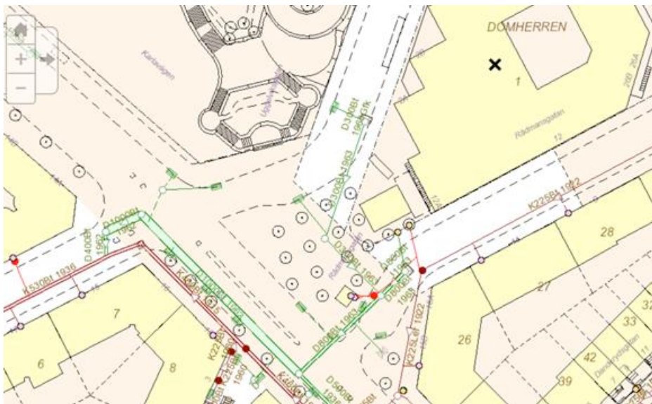
-Bild på ledningsnätet i gatan vid anslutningspunkten i fastighetsgräns
