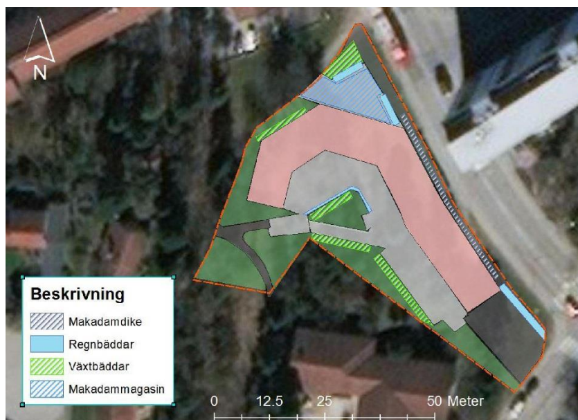
Principskiss för dagvattenlösningar med växtbäddar, makadamdike, regnbäddar och makadammagasin i områdets nordöstra del.
