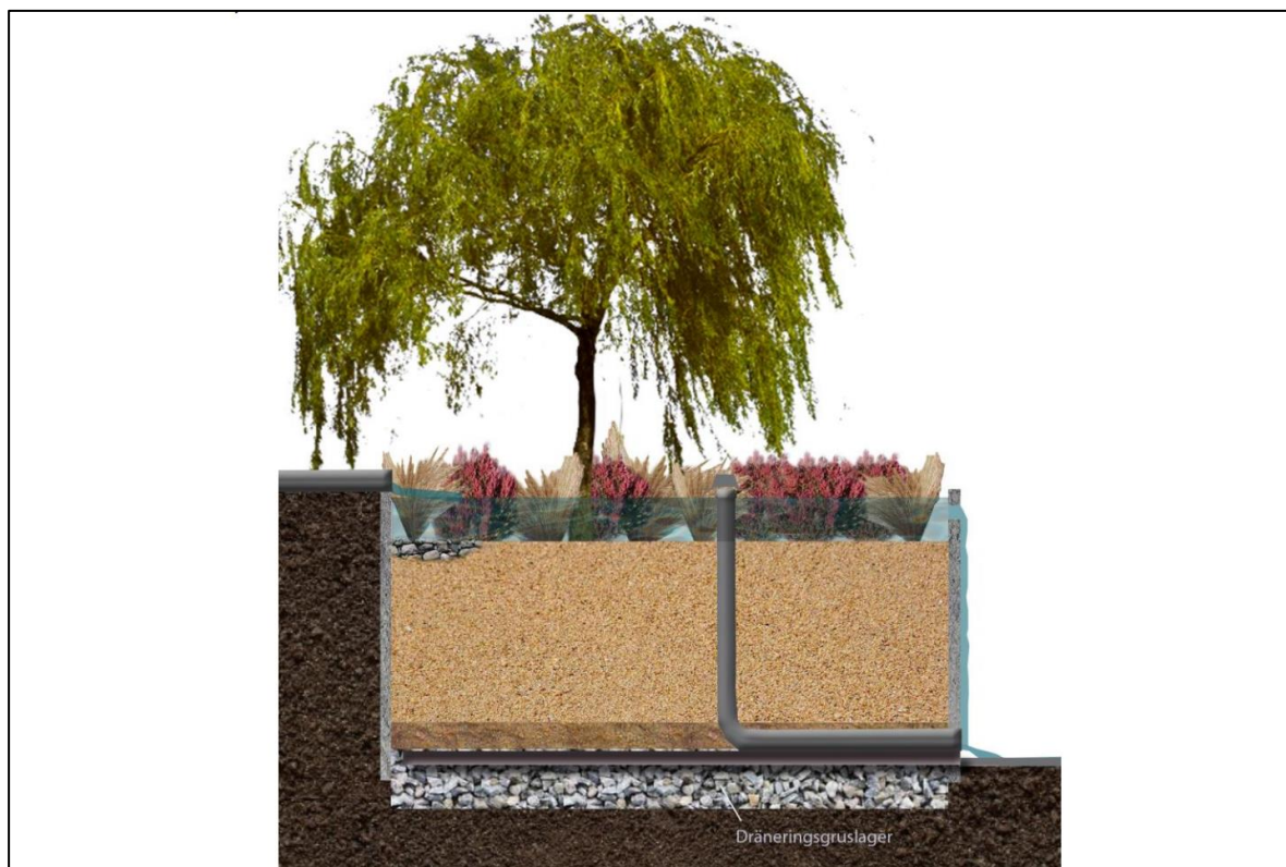
Figur 5-2. Illustration av hur en regnbädd kan byggas upp (Illustration Åsa Wellander).
