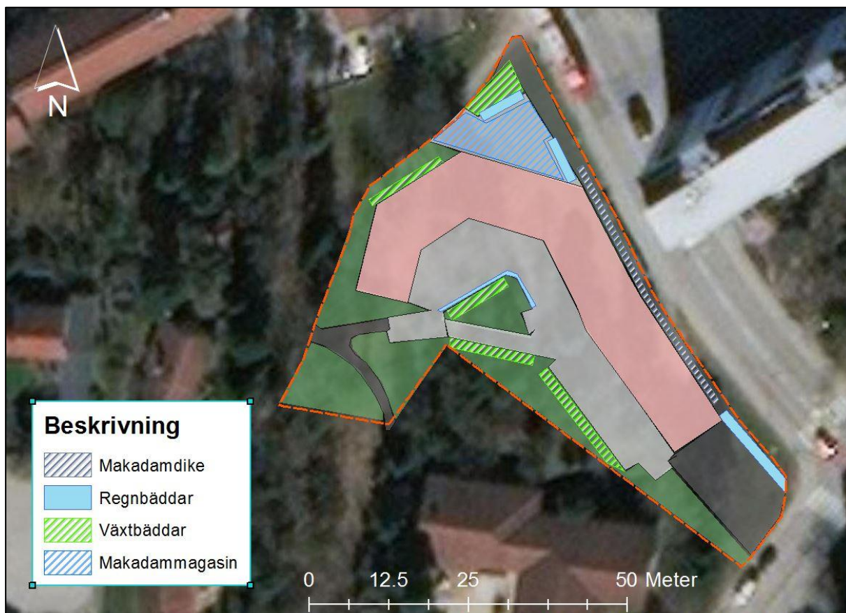
Figur 5-3. Principskiss för dagvattenlösningar med växtbäddar, makamdike, regnbäddar och makadammagasin i områdets nordöstra del.
