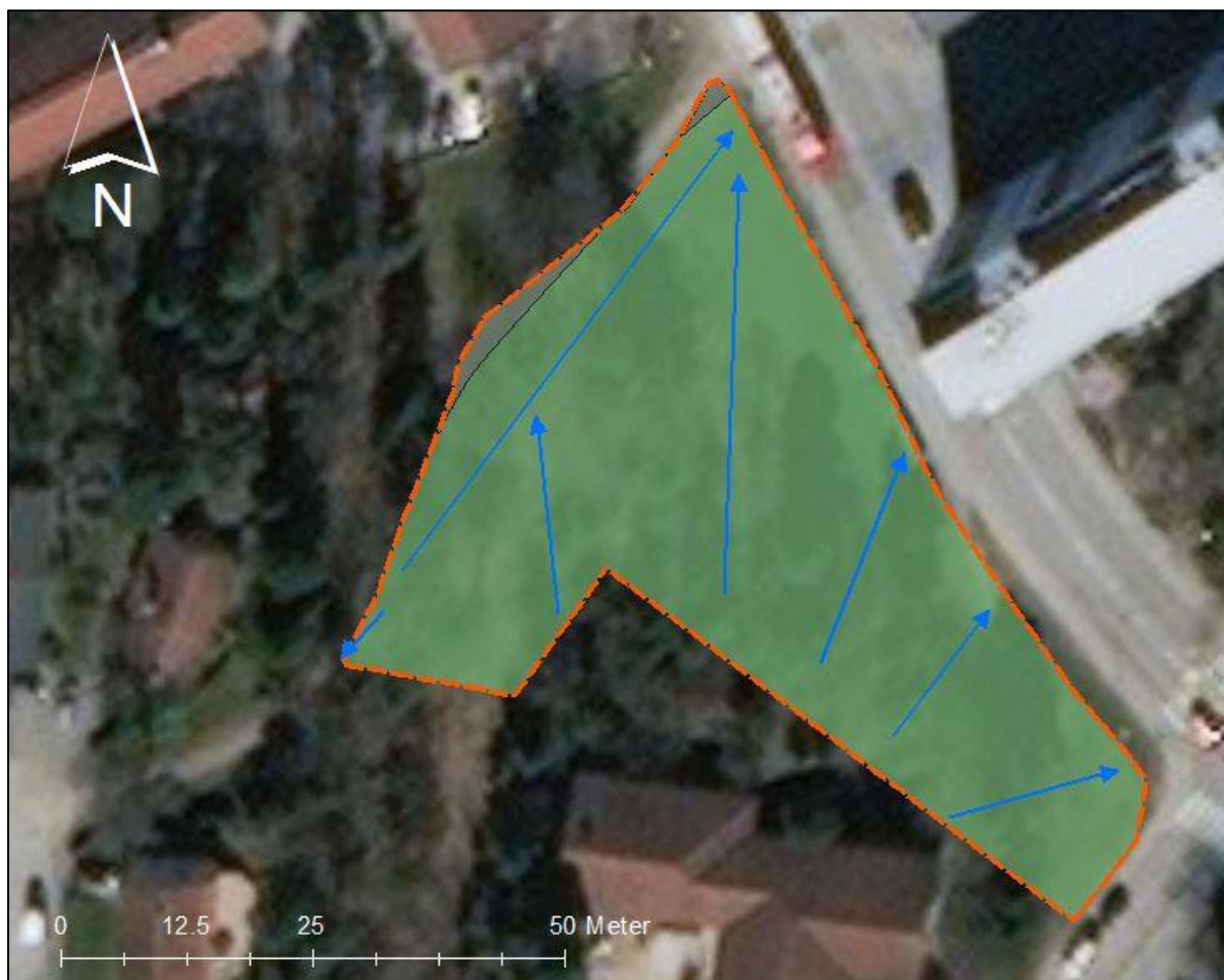
Figur 3-5. Översiktskarta över utredningsområdet vid Kaksulan, där blå pilar visar naturliga flödesriktningar för avrinnande dagvatten baserad på rådande topografi.
