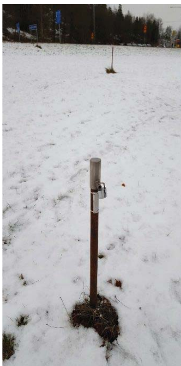
Figur 8 Bild som visar några av de grundvattenrör som sitter i den Östra delen av Skärholmsdalen.
