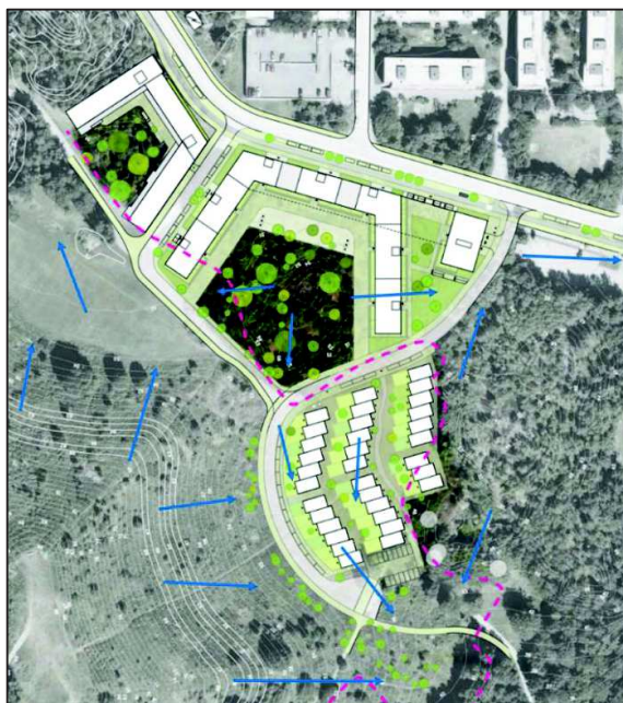
Figur 3. Planförslag med tolkade lutnings- och avrinningsriktningar. En bedömning av utfyllningens utbredning visas med röstreckad markering.
