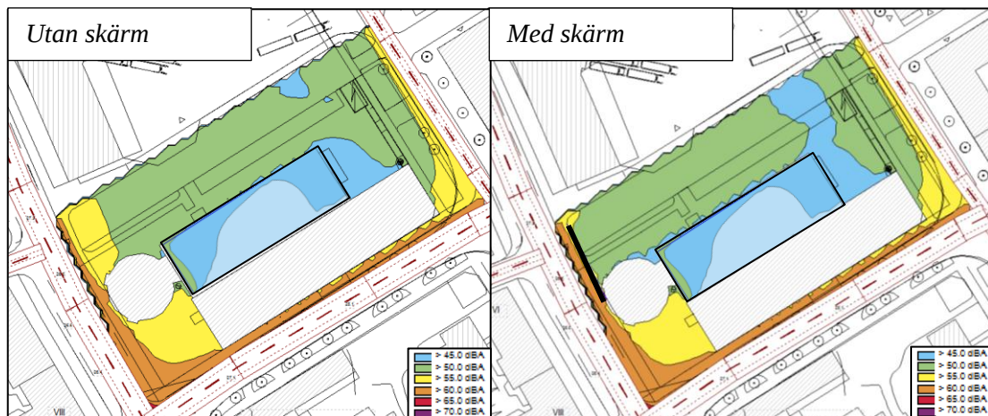
Figur 4. Sammanvägd ekvivalent ljudnivå före och efter skärmåtgärd. Skärmens placering markeras med svart linje. Ett 1,5 m högt räcke är placerat längs den upphöjda gårdens kant.
