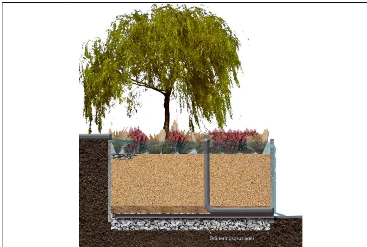
Figur 5-1. Illustration av hur en regnbädd kan byggas upp (Illustration Åsa Wellander).
