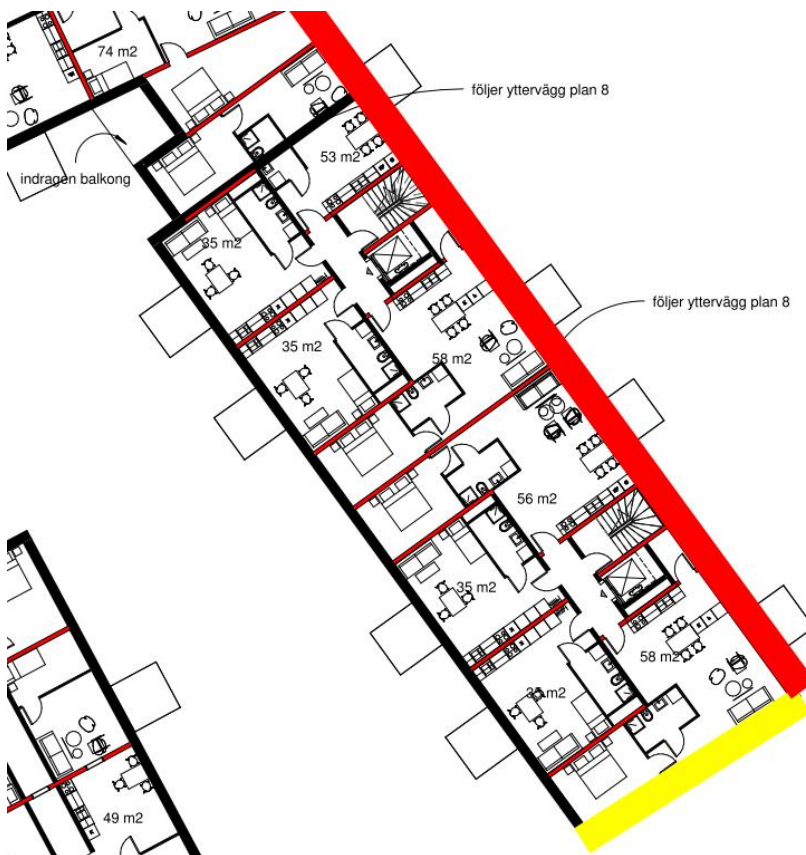
Figur 3. Planlösning normalplan (plan 04) för bullerutsatta bostäder, genomgående planlösning.
