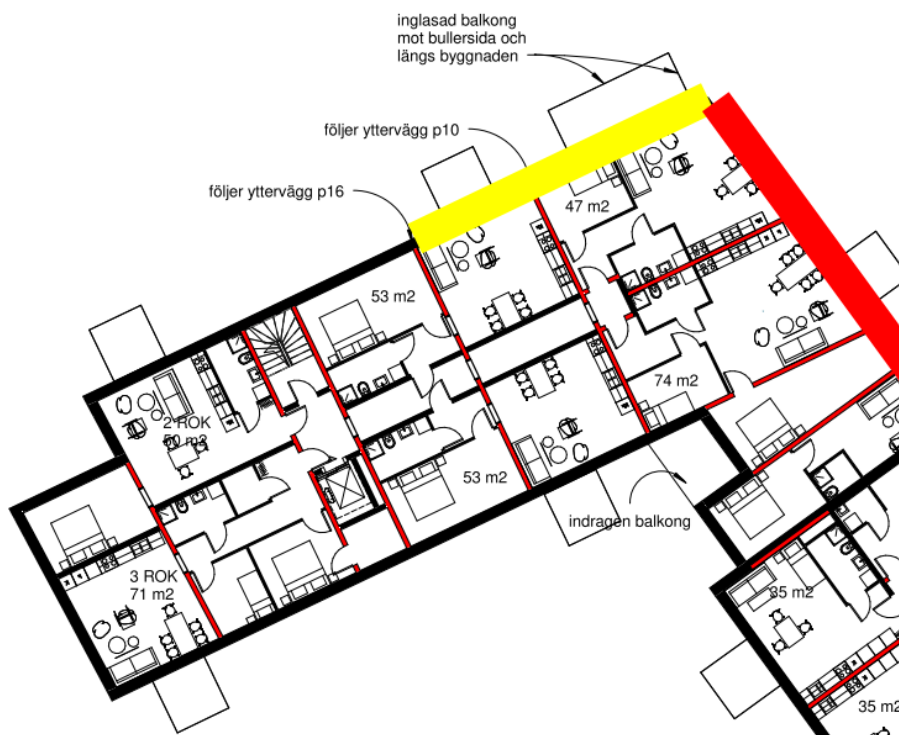
Figur 2. Planlösning normalplan (plan 04) för bullerutsatta bostäder, inglasning av balkong markerad för lägenhet i hörnläge bör kompletteras med absorbent i tak.
