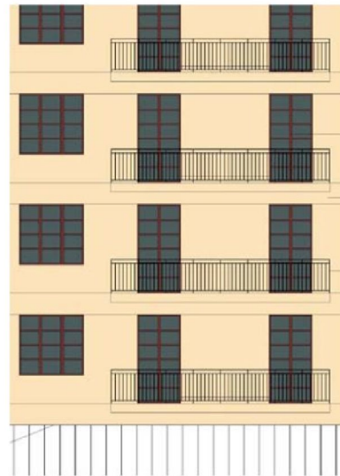
På gårdsfasaden uppförs nya balkonger och fönsterdörrar i befintligt fönsterläge.
