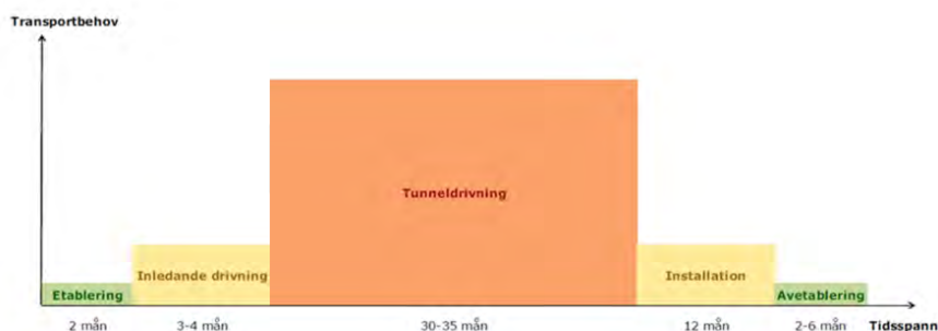
Figur 3.16 Översikt över byggfasens olika skeden. Tidsspannet skiljer sig mellan de olika tunneldelarna.
