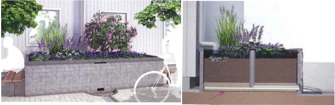
Figur 6 Till vänster: exempelbild på en upphöjd växtbädd/regnbädd. Till höger: sektion av regnbädd med tät duk under så att vatten inte riskerar att skada grundläggning (Movium, 2015).
