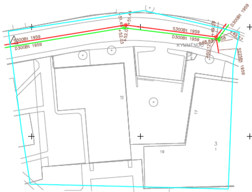
Figur 5. Befintliga VA-ledningar i anslutning till fastigheten, planområde markerat med cyanfärgad linje. (Grön: dagvatten, röd: spillvatten).
