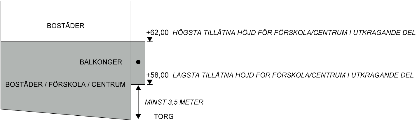
Illustration: sektion som visar hur balkonger ovan allmän plats (torg) får anordnas.
