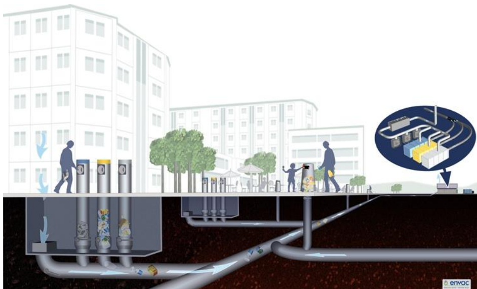
Bild 01 Princip sopsug Källa: Envac
