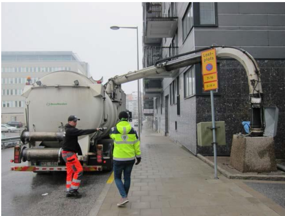
Bild 02 Tömning med mobil sopsugsbil. Källa: Stockholm Vatten
