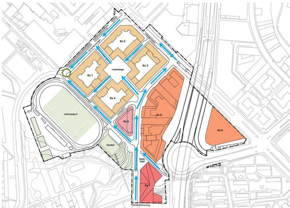
Figur 1 .Blå pilar visar flödesriktning. Grön cirkel visar läge för anslutningspunkt till ledning D600 i Nordenflychtsvägen.
