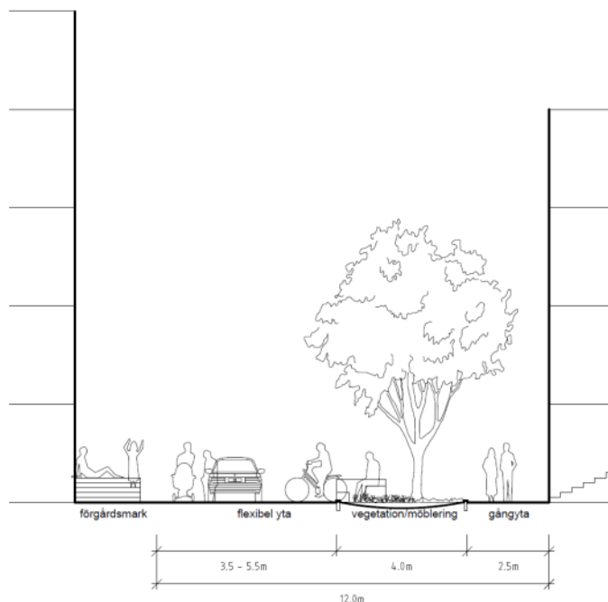
Sektion gångfartsgata mellan kvarter B och C (Andersson Jönsson Landskapsarkitekter)
