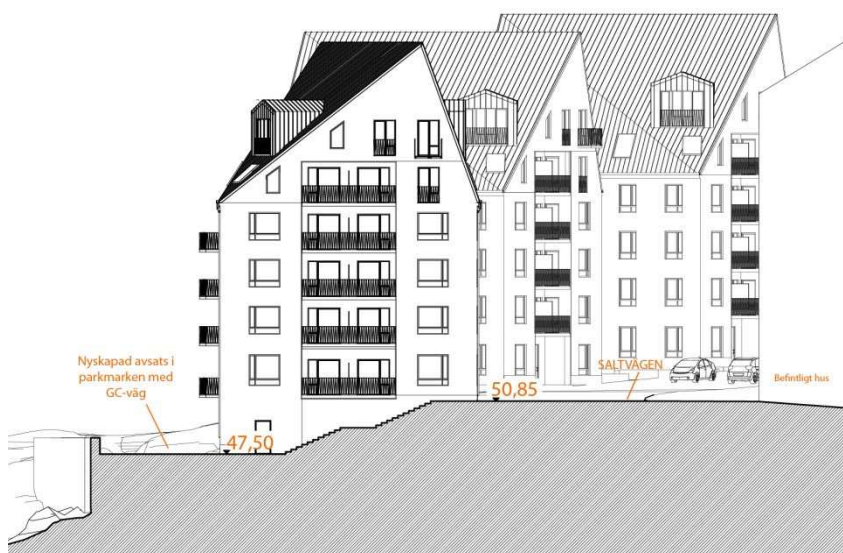
Sektion genom Saltvägen, kvartersmarken och den skapade avsatsen i parkmarken. Bild: Backhans och Hahn arkitekter/Zin arkitektur
